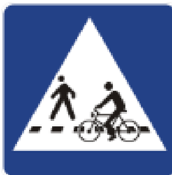
Slika 6: Prehod za pešce in kolesarje
